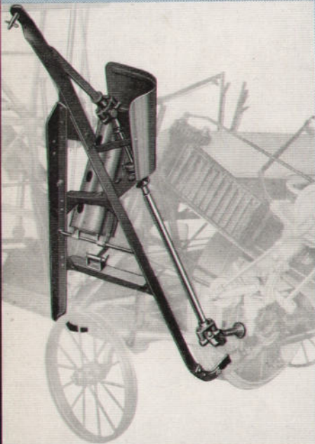
Der vordere Elevatorantrieb und der untere Haspelantrieb sind gefapselt. Der rotierende Stoppelendglätter wird durch eine Rollenkette angetrieben. Die Treibränge hat am oberen Ende ein ungeteiltes Federblatt
