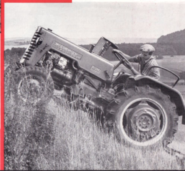
Leichte Lenkung, kleinster Spurenhalbmesser (mit Lenkbremse) 2550 mm
