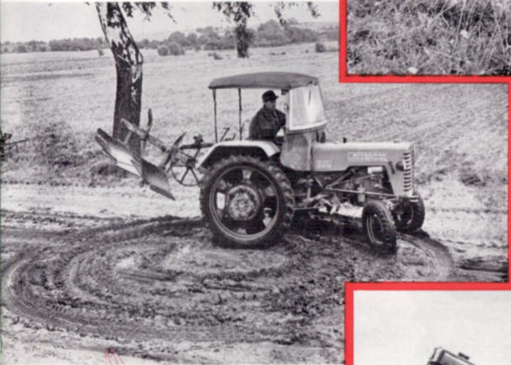
Leichte Lenkung, kleinster Spurenhalbmesser (mit Lenkbremse) 2550 mm
