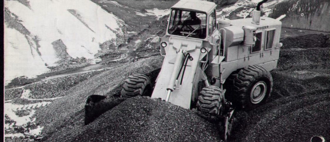
INTERNATIONAL PAYDOZER D-120 C mit Knicklenkung - 380 PS - Räumbreite 4,15 m
