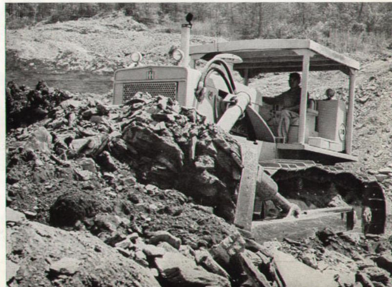
INTERNATIONAL Industrielader D-3439 39 PS 0,43 m³ Schaufelinhalt
