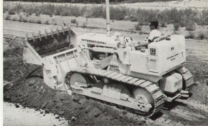
INTERNATIONAL Laderaupen 150 96 PS - 1,15 m³ Power Shift-Getriebe
