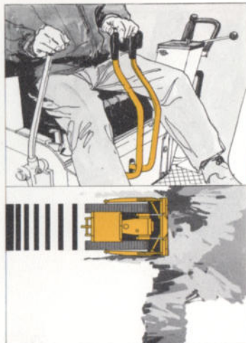
3. Anziehen der Hebel nach hinten: Beide Ketten werden sofort abgebremst. Der Kraftfluß zwischen Getriebe und Endantrieb ist unterbrochen.
