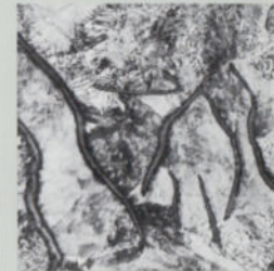
Gefüge Vergrößerungen a) Gußeisen mit Lamellen-graphit V = 200:1
