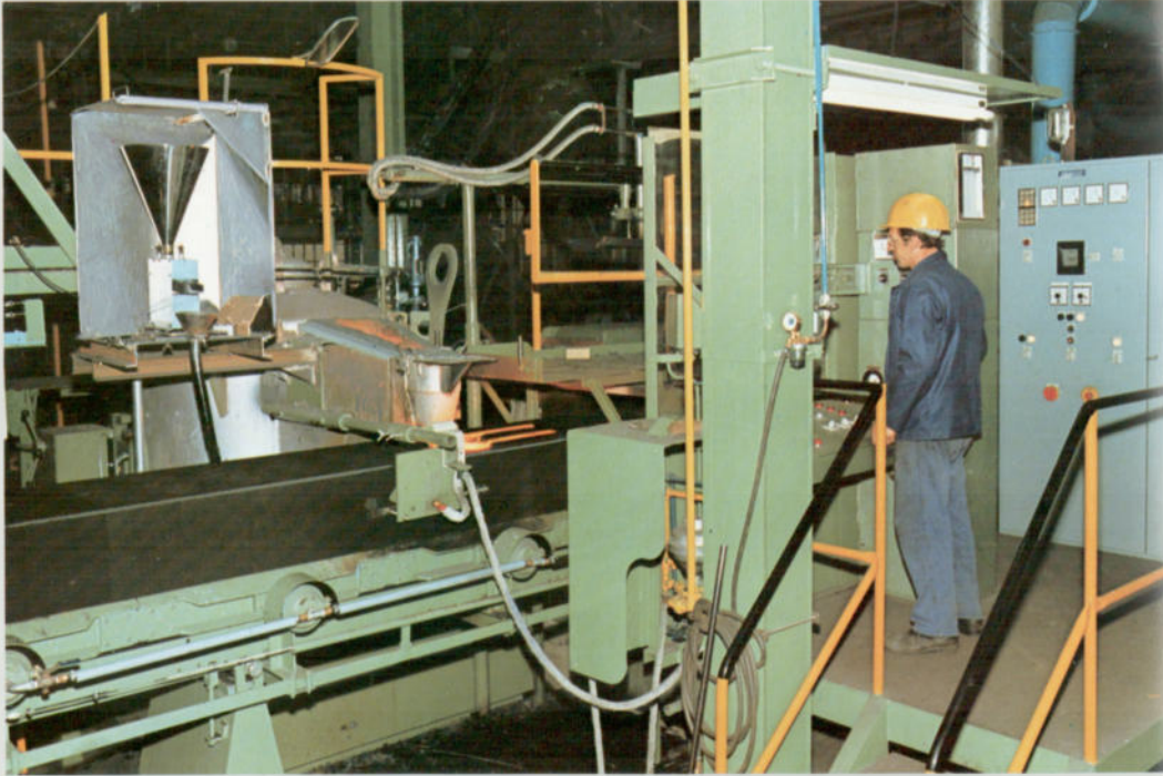
1. DISAMATIC-Formautomat Ballengröße 480 x 600 mm (120-330 mm)
