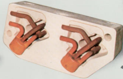
5. Gußteile aus der DISAMATIC- Serienfertigung
