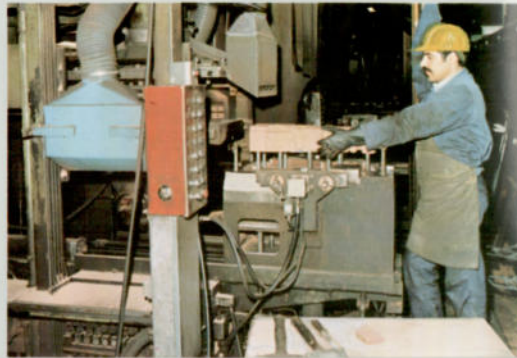
1. Drehkreuzanlagen für serienmäßige Herstel- lung von Croning- und Hotboxkernen
