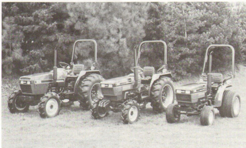
Das Trio der neuen Case IH-Kompaktschlepper der Serie 200. Von rechts: der kleinste Schlepper Typ 235, der Typ 255 und das mit 29 PS Antriebsleistung stärkste Gerät, der Typ 275.
