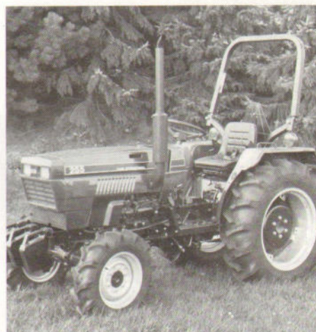
Der Case IH-Kompaktschlepper Typ 255 nimmt mit 23 PS Antriebsleistung die mittlere Position innerhalb der 200er-Serie ein.
