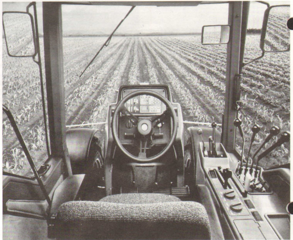
Der Fahrerstand der Magnums gleicht einer Schaltzentrale mit modernsten elektronischen Anzeigeelementen
