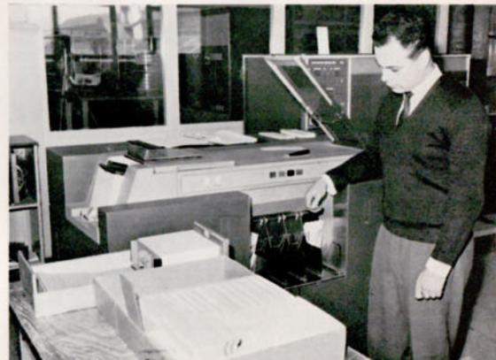
Das ist eine sogenannte Eingabe- und Stanzeinheit der Type 1401. Sie hat eine Kartenlesegeschwindigkeit von 48 000 und eine Stanzgeschwindigkeit von 15 000 Karten pro Stunde.
