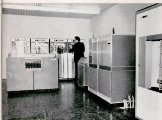
Diese moderne elektronische Datenverarbeitungsanlage der Type I B M 1401 mit Magnetbandeinheiten und Magnetplattenturm, die wir hier im Werk haben, kann alle die oben geschilderten Arbeiten in einem Arbeitsgang erledigen. Wenn man in diesem Raum steht, kann man nur staunen.
