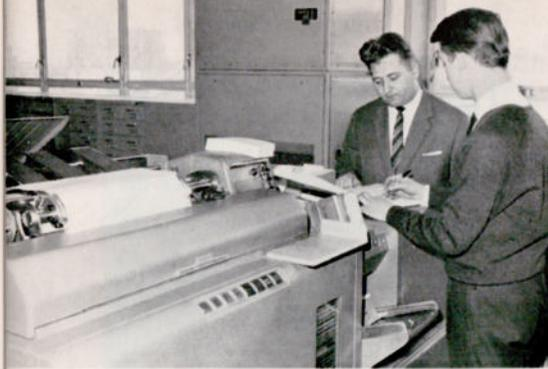
Mit der Tabelliermaschine werden z. B. Lohnlufen oder Banküberweisungen geschrieben, und zwar schreibt diese Maschine 9 000 Zeilen à 100 Zeichen in der Stunde.
