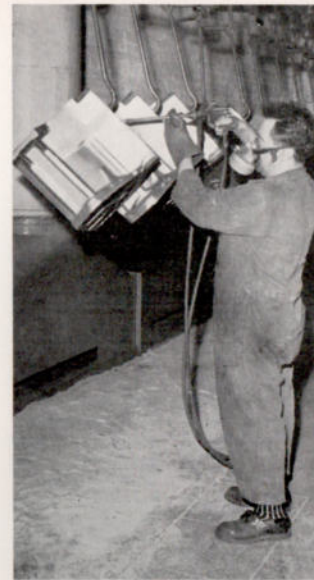
Beim Spritzen und Tauchen der Gußteile entstehen Farbnebel, die sehr ungesund sind. Durch die Raumentlüftung werden diese Nebel entfernt (Ventilatoren mit Absaugschlitzen). Es muß natürlich sofort Frischluft nachgepumpt werden.
