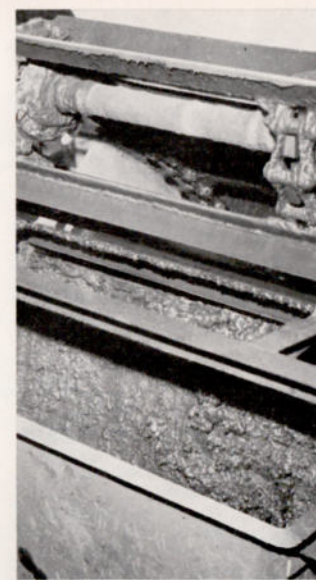
Auf diesem Bild sehen wir die Behälter, in denen der mit Wasser verbundene Staub abgelagert wird.
