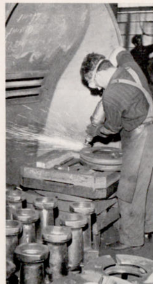
Auf diesem Putzstand mit Absaughaube sind deutlich die verstellbaren Langschlitze zu sehen. Hier werden die umherfliegenden Teilchen sofort abgesaugt. Ca. 3000 m 3 verunreinigter Luft verschwinden pro Stunde in diesen Öffnungen.
