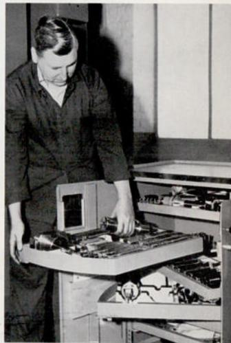
**18. Zwischenkontrolle:** Alle vorgefertigten Teile werden vor dem Zusammenbau oder Weiterverarbeitung einer strengen Prüfung unterzogen.
