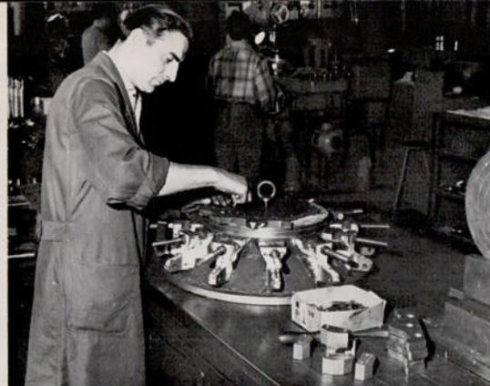
23. Werkzeugschlosser: Montieren der Einzelteile einer Fräsvorrichtung für Ölpumpengehäuse.
