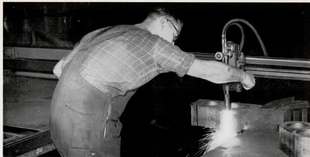
1. Brennerei: Autogenes Ausbrennen mit modernen Brennmaschinen der Bauelemente für Vorrichtungen.
