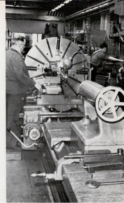
**8. Drehbank:** Schmiedeform nachdrehen an einem Fallhammergesenk.
