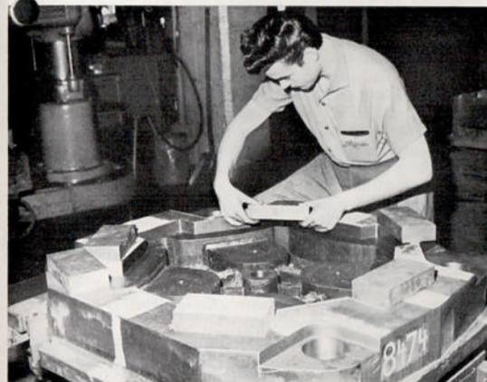
27. Werkzeugschlosser: Einpassen des Schneidmessers am Unterteil des Schnittwerkzeuges für Hinterradschüssel.
