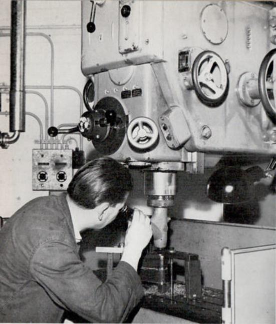
**13. Lindner Bohrwerk:** Ausrichten einer Lochstellungslehre zum Bohren mit Hilfe eines Anvisiermikroskops.
