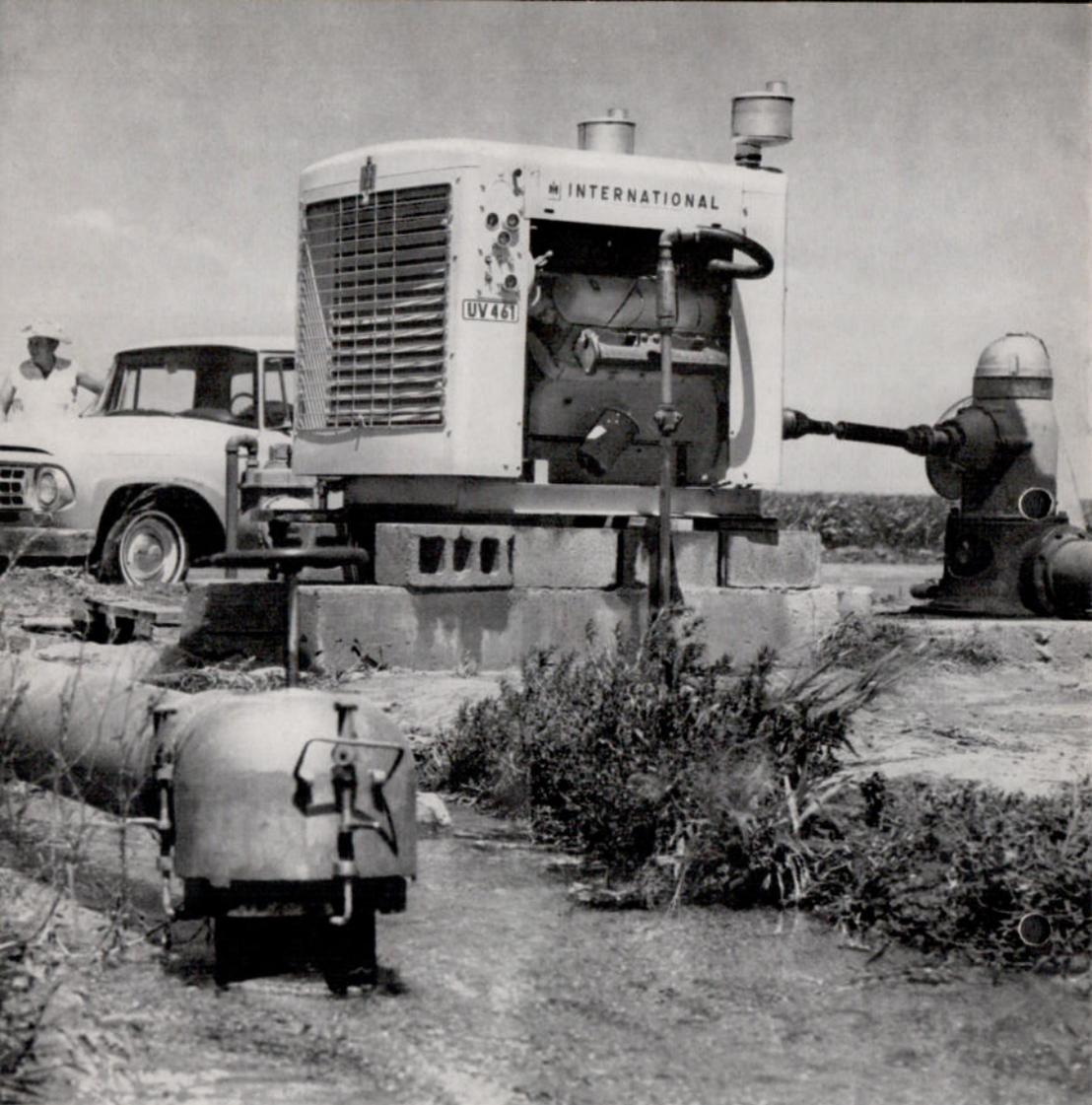
In Texas arbeitet diese 162-PS-IH-Wasserpumpe, die von Naturgas getrieben wird. Sie pumpt pro Stunde 3785 l Wasser aus einer Tiefe von 82 Metern, um eine Fläche von 40 ha zu bewässern.
