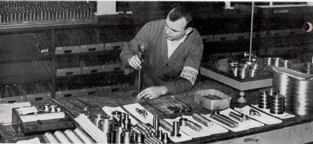
**19. Messerkopfschleifmaschine:** Hier werden Messerköpfe zum Planfräsen sowie spezielle Messerköpfe zum Fräsen von Kubelwellenlagern geschärft.
