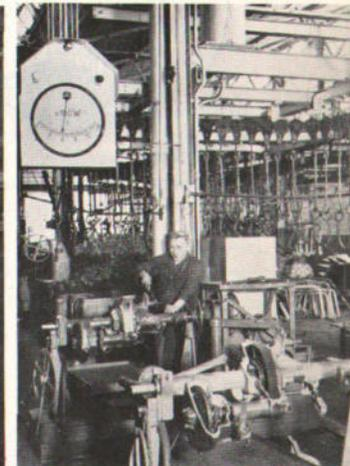
Bearbeitung der Radnaben des D-10 Grasmähers. (links)
