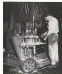
Auf dieser Mehrspindelbohrmaschine kann in einem Arbeitsgang eine Vielzahl von Löchern gebohrt werden.
