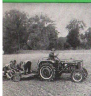
Auch zum Pflanzenseßen sind die neuen Farmall-Schlepper zu verwenden. Das 5-Gang-IH-Präzisionsgetriebe erlaubt Geschwindigkeiten vom Kriechgang bis zu 20 km/Std.
