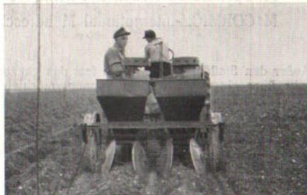
Beim zweireihigen Gerät ist außer dem Schleppfahrer nur noch ein Mann notwendig, der die Vorratskammern der Fehlstellenverhütung nachfüllt.
