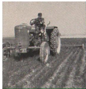
Die neuen Farmall Dieselschlepper eignen sich dank der vielseitigen Spurverstellung hervorragend für Pflege- und Bestellarbeiten in Reinkulturen.
