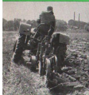
Der Farmall D-3 Dieselschlepper mit 2-Scharpflug, mit 3-Punktaufhängung und hydraulischem Kraftheber.
