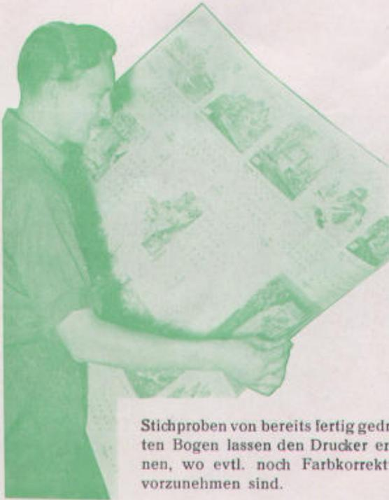
Stichproben von bereits fertig gedruckten Bogen lassen den Drucker erkennen, wo evtl. noch Farbkorrekturen vorzunehmen sind.
