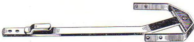
Der vordere Bügel (s. Abb.), an welchem die Gerätezugstange drehbar gelagert ist, wird vorne am Getriebekasten befestigt. Die hierdurch erreichte Verlegung des Zugpunktes vor die Hinterachse gibt dem Schlepper eine besonders gute Adhäsion und damit erhöhte Durchzugskraft, was sich besonders bei schwerem Pflügen und Grubbern angenehm auswirkt. Die Verlegung des Zugpunktes vor die Hinterachse erleichtert das Wenden mit angehängten Geräten wesentlich,
