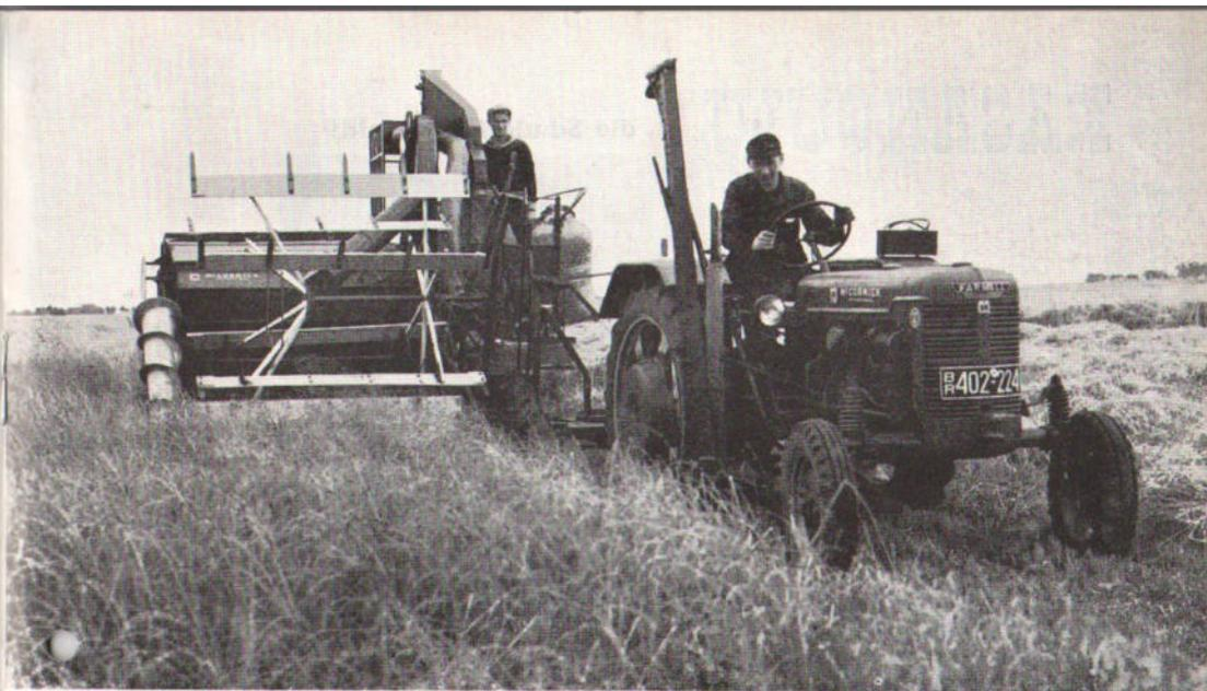
Ein McCormick Farmall Dieselschlepper DGD-4 arbeitet sich mit einem McCormick Mähdrescher D-64 durch schwersten Lagerroggen.
