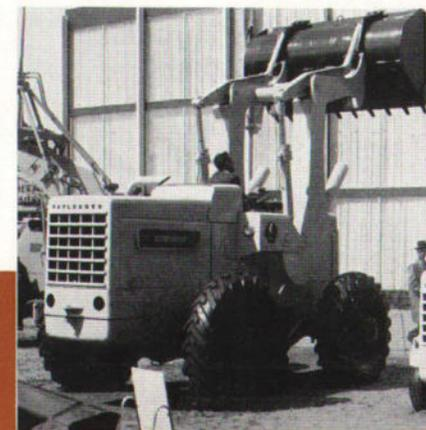
Vier Geräte in einem - genau das bedeutet „DROTT 4 in 1“: Planierschild, Ladeschaufel, Schürfrübel, Greifer.
