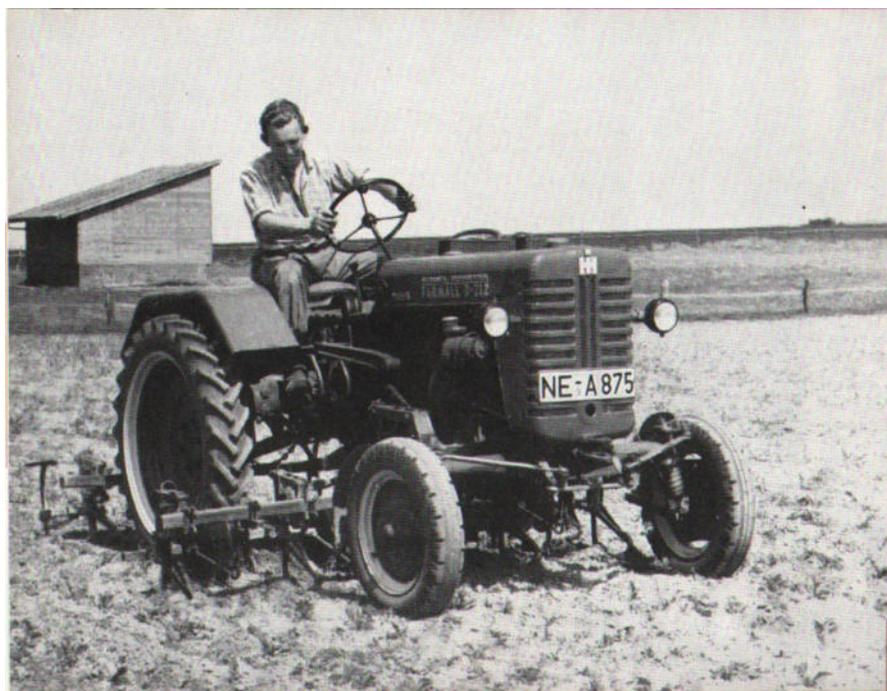
Es gibt keine unerwünschten Bodenverdichtungen, denn zwei Hackkörper an der Dreipunktaufhängung lockern bei dem McCormick International Zwischenachsgerät die Spuren des Schleppers.
