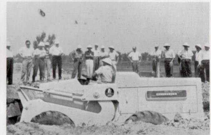
Ein IH-Payloader beim Ausheben einer Baugrube.
