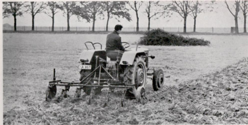
Der Kraftheber dient vor allen Dingen der Betätigung von Anbaugeräten an der – später zu erwähnenden – Dreipunktaufhängung, wie Beet-, Winkel- und Völdrehpflug, Dreipunktwechsel-pflug, Grubber, Egge, Rotorkrümler, Dreipunktack- und Pflegegeräte u. v. a. m.
