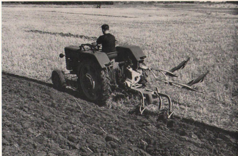
Bei diesen Pflügen sind Anbau- und Drehteil nicht mehr hintereinander angeordnet, sondern in einem Kopf vereinigt. Bei unverändertem Körperabstand baut dadurch der ganze Pflug bis zu 30 cm kürzer als die bisherigen Typen. Es braucht wohl kaum noch erwähnt zu werden, daß die Tendenz zur Entlastung der Vorderachse erheblich vermindert. Aber, wie schon gesagt, ist das nicht der einzige Vorteil dieser neuen Geräte.
