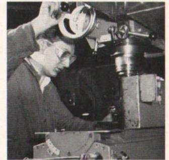
Bearbeitung eines Versuchsteils auf der Fräsmaschine.
