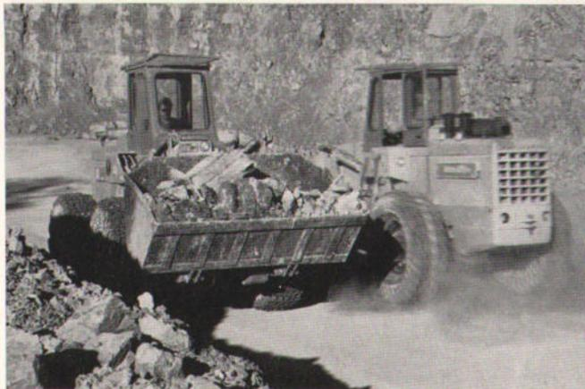
In 9<sup>1</sup>/<sub>2</sub>stündiger Arbeitsschicht werden mit zwei PAYLOADERN (H-90) durchschnittlich 750 t Material gefördert, eine Leistung, die unter Berücksichtigung des 130 m langen Fahrweges mit einer Steigung von 15% beachtlich hoch ist.
