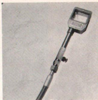
Abb. 4 Kompressionsdruckschreiber „Motorometer“.
