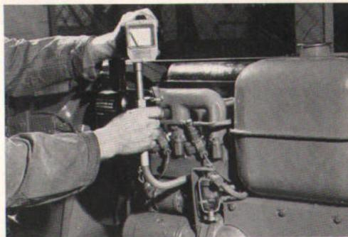
Abb. 6 Kompressionsdruckprüfung an einem DD-74-Motor.
