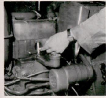
Ermittlung der Abgastemperatur des 2-Zylinders eines DD-74 Motors bei Verwendung von Thermochromstiften. Abbildung 4
