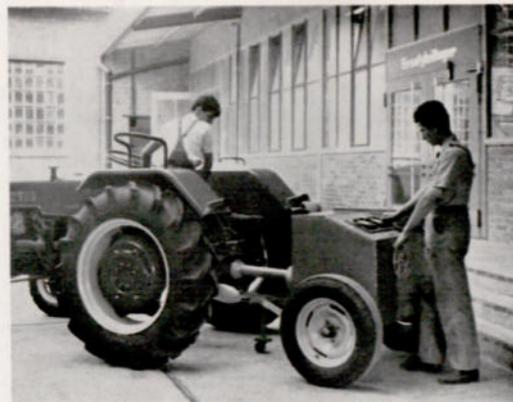
Fahrbare Motorenbremse „Hydra Electric Dynamometer - P-500“, angeschlossen an einen D-430-S Schlepper. Generalvertreter für die Bundesrepublik: Fa. Fr. Brandenburg, Brebach, Saar. Abbildung 8
