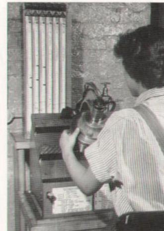
Pneumatisches Meßgerät zum gleichzeitigen Messen von 3 Durchmessern, des Taumelschlages und der Konzentrizität.
