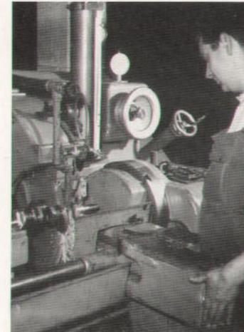
Pneumatisches Meßgerät zum Messen während des Schleifvorganges.
