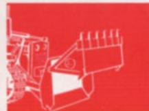
**Planieren.** Die Schnittkante wird durch Veränderung des Schnittwinkels hydraulisch eingestellt.
