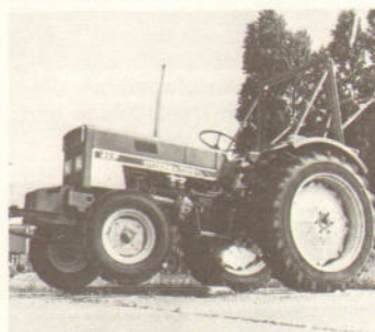
Prüfung eines automatisch-gesteuerten Schleppers auf der Schwellenbahn
