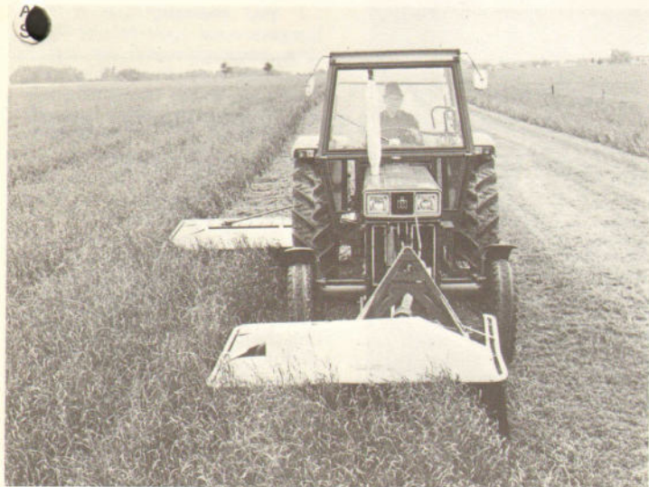
Die neue Frontzapfwelle an IH-Traktoren ermöglicht weitere Arbeitssteigerungen. Hier mit zwei PZ-Kreiselmäherwerken, die in der Front-
