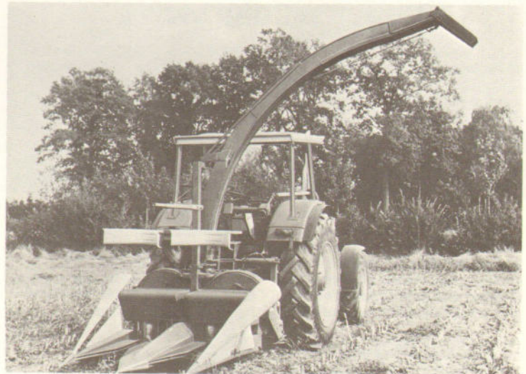
Die höchsten Arbeitsleistungen erreicht der PZ MH 160 beim Einsatz von 2 bzw. 3 zur Verfügung stehenden Ladewagen, die im ständigen Arbeitsfluß nebenher fahren und das Häckselgut aufnehmen, und zu den entsprechenden Silos transportieren.
