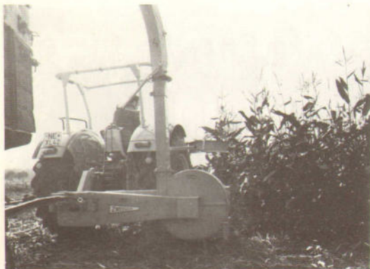
Der erfolgreiche PZ MH-80 (l. einreihig) sowie die Weiterentwicklung PZ MH-160 (r. zweireihig) zeichnen sich u. a. durch eine denkbar einfache Konzeption, hohe Leistung und außergewöhnliche Wartungsfreundlichkeit aus.
