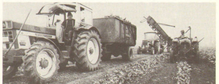
Bei der Zuckerrüben-ernte werden die fünfzeiligen Geräte — Köpfer, Roder und Rübenlader — absetzig eingesetzt, so daß insgesamt 5 Schlepper einschließlich des Rübenabfahrens zur Feldmiete zur Verfügung stehen müssen.
