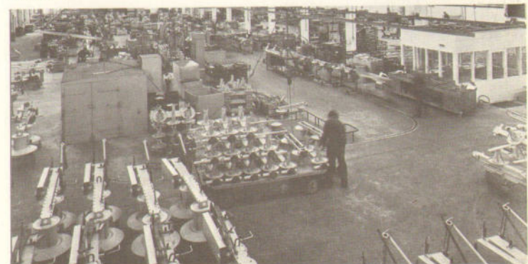
Großzügig angelegte Fertigungsstraßen ermöglichen eine rentable Fertigung. Hier die Fertigung der PZ-Kreismäher. Erstaunlich für den Besucher ist die ständige Berieselung mit Unterhaltungsmusik während des gesamten Tages in fast allen Fertigungsbereichen.
