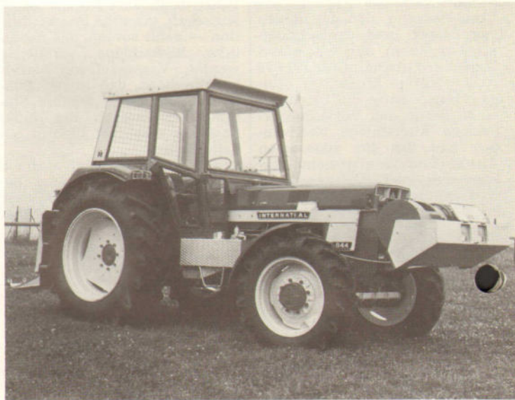
INTERNATIONAL Perfect-Schlepper, Typ 844 mit NAGEL Rückeaggregat (Zwillingsseilwinde) Frontanbau und Heck-Portalrahmen.
