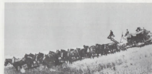
Ein seltener Anblick für unsere Breitengrade waren die schon um die Jahrhundertwende in den USA entwickelten Mährescher. Je nach Getreideabstand und Beschaffenheit des Geländes, mußten 20 bis 36 Pferde vor dieses „Ungetüm“ gespannt werden.
