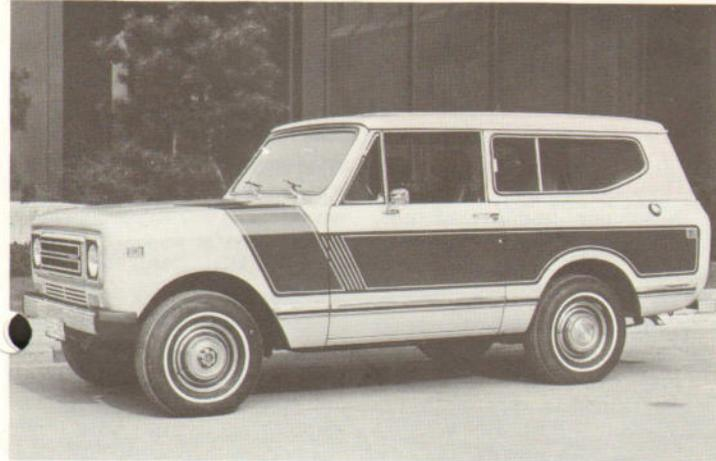
Ein Universalfahrzeug mit PKW-Komfort – wird in 2 Versionen mit 66 kW (90 PS) sowie V8-Motor mit 120 kW (163 PS) ausgeliefert.
