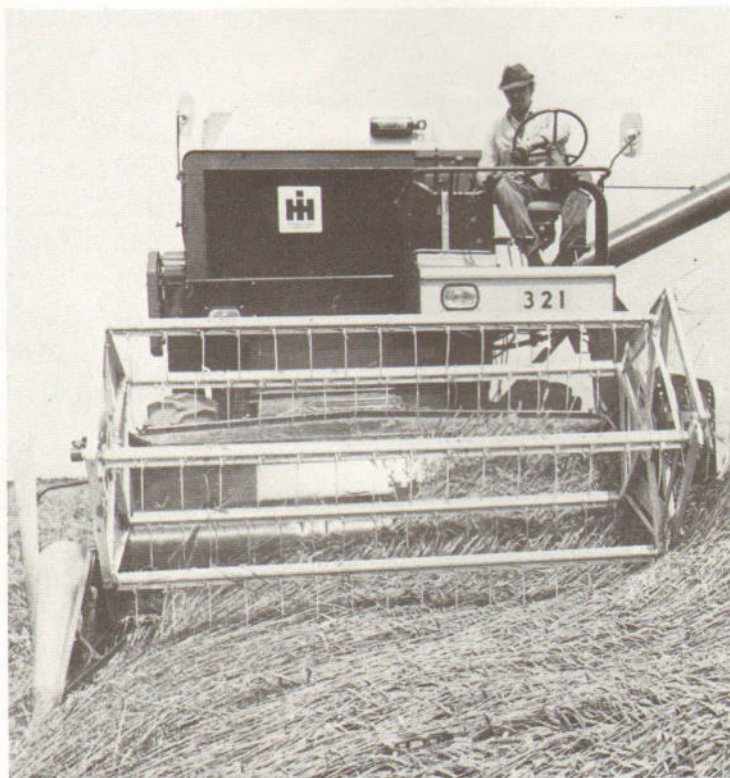
Der „Kleinste“ aus dem Gesamtmähdrescher-Programm der IH/Deutschland. Die auswechselbare Plattform erlaubt auch bei dem „321“ Schnittbreiten von wahlweise 2,60 m oder 3,10 m.
