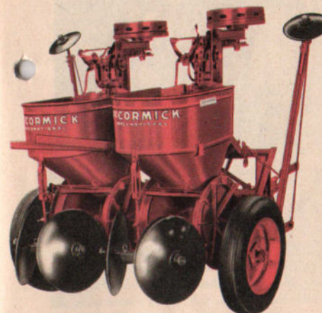
Dreireihige Kartoffellegemaschine für Schlepperzug. Gewicht ca. 460 kg, mit verstellbarer Spurweite und Gummibereifung. Fassungsvermögen 210 kg.
