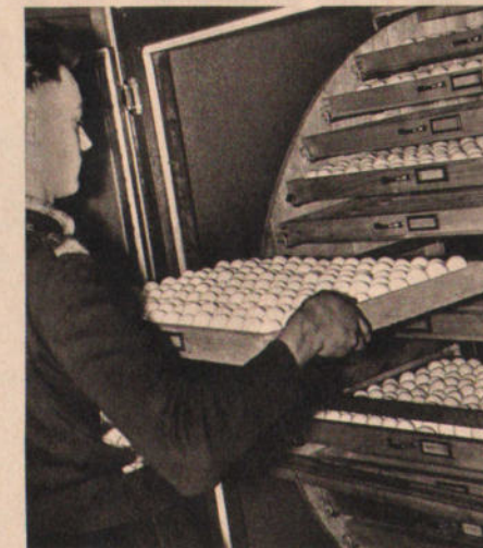
Von einem fahrbaren Sammelgestell aus, hier unsichtbar im Rücken des Helfers, werden die Eier in die Brutraumtrommeln geschoben, die nach modernsten Erkenntnissen gebaut sind.
