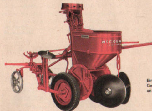
Dreireihige Kartoffellegemaschine für Schlepperzug. Gewicht ca. 460 kg, mit verstellbarer Spurweite und Gummibereifung. Fassungsvermögen 210 kg.
