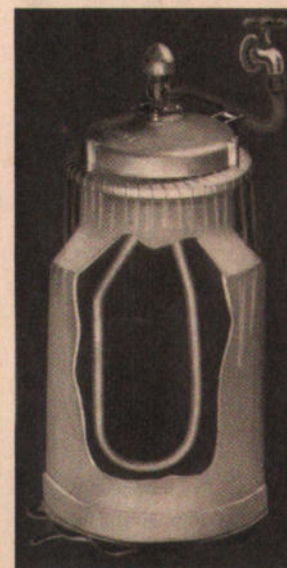
Schnittbild eines UTINA-Einzelkannen-Milchkühlers. Die Zweikreis-Innenkühlung und die Außenberieselung ergeben einen hohen Kühleffekt. Lieferbar für 20-, 30- und 40-l-Kannen
