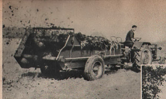
Auch das mechanische Miststreuen wird durch die Zapfwelle ermöglicht.
