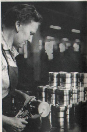
Motorblock wertlos. Heute setzt man in den Motorblock besondere Zylinderbüchsen ein. Sie bestehen aus einem hochwertigen Spezialguß und können verhältnismäßig leicht ausgewechselt werden. Das ist ein großer Fortschritt, gerade bei Motoren, die für Acker-schlepper bestimmt sind, denn diese Motoren unterliegen einer besonders starken Beanspruchung.
