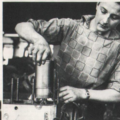
Die Zylinderbüchse mit Kolben und Pleuel wird in den Motorblock eingesetzt. Maßgenaue Vorarbeit sorgt für richtigen Sitz der Zylinderbüchse.
