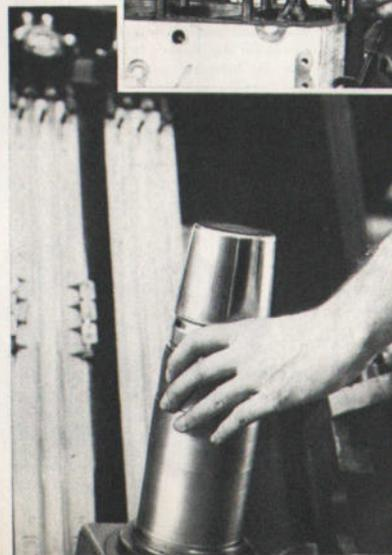
Jede Zylinderbüchse wird auf ein Prüfergerät aufgesetzt und gedreht. Auf den daneben befindlichen Maßskalen wird die Genauigkeit der zylindrischen Bohrung abgelesen.
