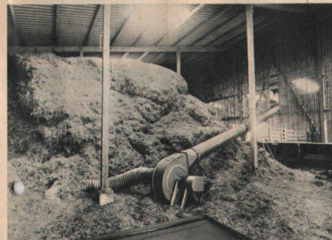
Das erdlastig vor dem Stall gelagerte Häckselstroh wird von dem breiten Maul des Wurfgebläses angesaugt und in den Stall geblasen.
